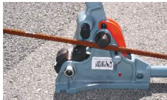
Positionnement du fer à béton pour cintrer.
