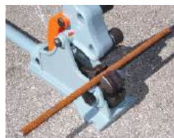
Positionnement du fer à béton avant la coupe.
