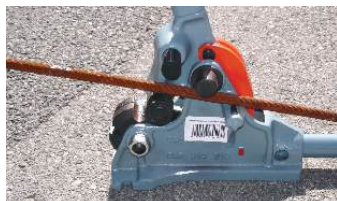
Positionnement du fer à béton pour cintrer.
