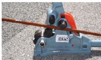
Positionnement du fer à béton pour cintrer.
